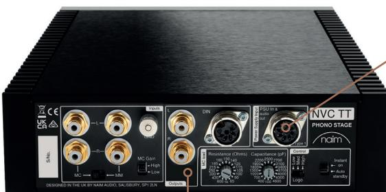
Entrée Burndy et sortie du signal audio, pour produits compatibles câble Type 1
