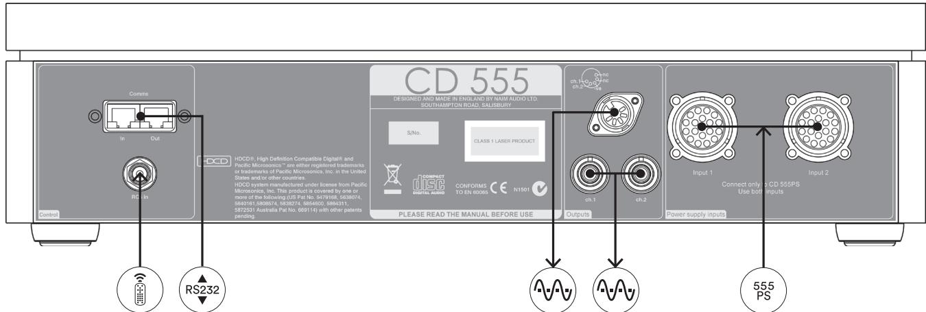
Note : L'entrée RC5 est conçue pour recevoir les signaux de commande externes pour les installations multi-pièces. Pour de plus amples renseignements, veuillez contacter votre revendeur ou directement Naim Audio. La prise optionnelle d'interface RJ45 comm. permet de commander le lecteur à distance dans les installations personnalisées. Pour de plus amples renseignements, veuillez contacter votre revendeur ou directement Naim Audio.
