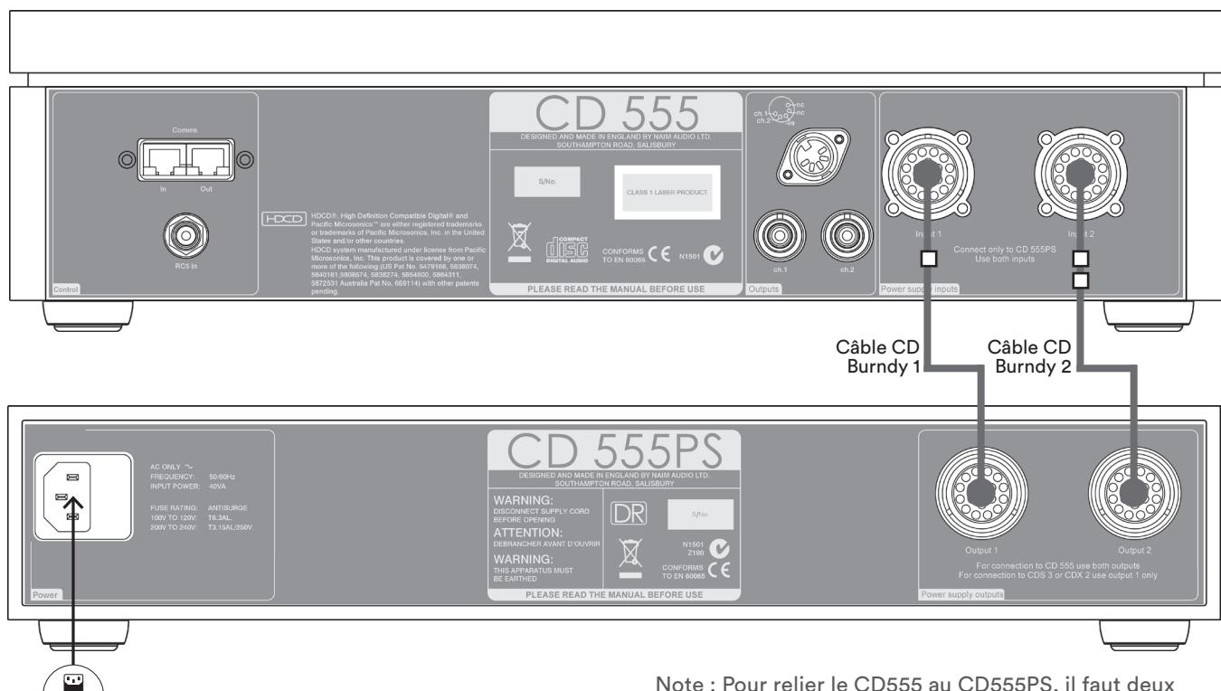
Note : Pour relier le CD555 au CD555PS, il faut deux câbles Burndy différents. Le câble 1, qui est marqué d'une seule bande d'identification sur sa gaine d'orientation, relie les prises femelles 1, et le câble 2, qui est marqué de deux bandes d'identification sur sa gaine d'identification, relie les prises femelles 2.
