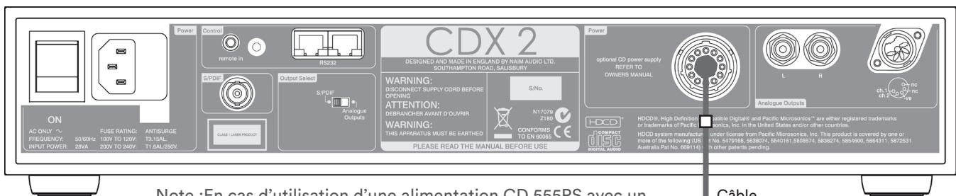
Note : En cas d'utilisation d'une alimentation CD 555PS avec un lecteur CDX2, utiliser uniquement la prise de sortie alimentation N° 1.
